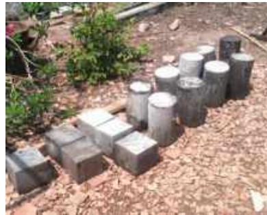
Hình 2. Mẫu BTXM sau khi đúc mẫu kéo và nén
