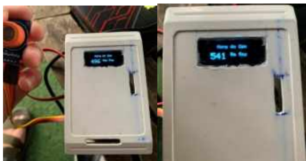
Hình 18. Kết quả nồng độ cồn trong 2 lần đo được hiển thị trên màn hình OLED
