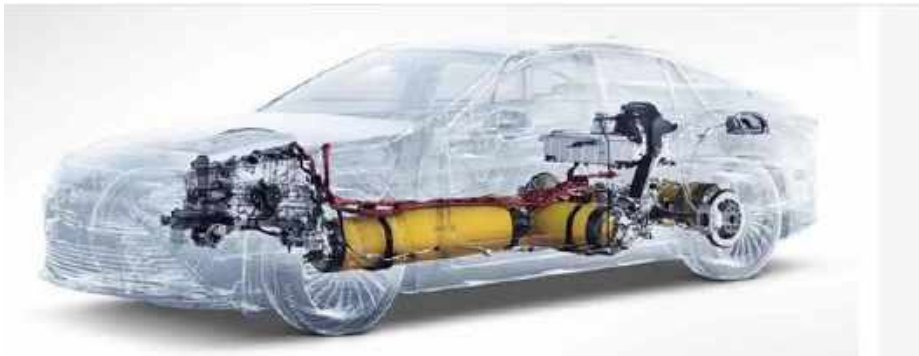
Hình 10. Thiết kế 1 chiếc xe chạy bằng PEMFC của Toyota
