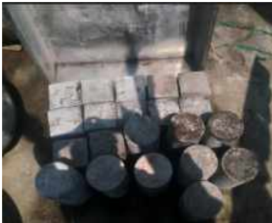
Hình 2. Mẫu BTXM sau khi đúc mẫu kéo và nén
