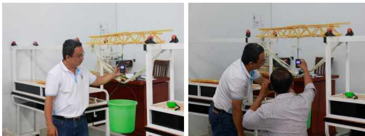
Hình 2. Thử nghiệm sức chịu tải của mô hình kết cấu cầu 1 nhịp
