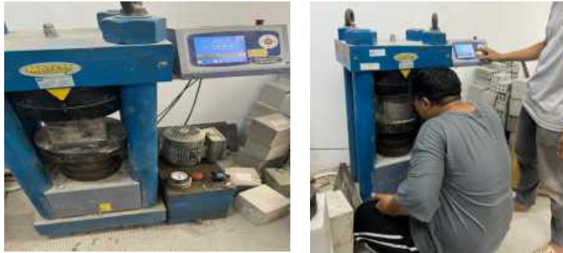
Hình 4. Thí nghiệm cường độ chịu nén
