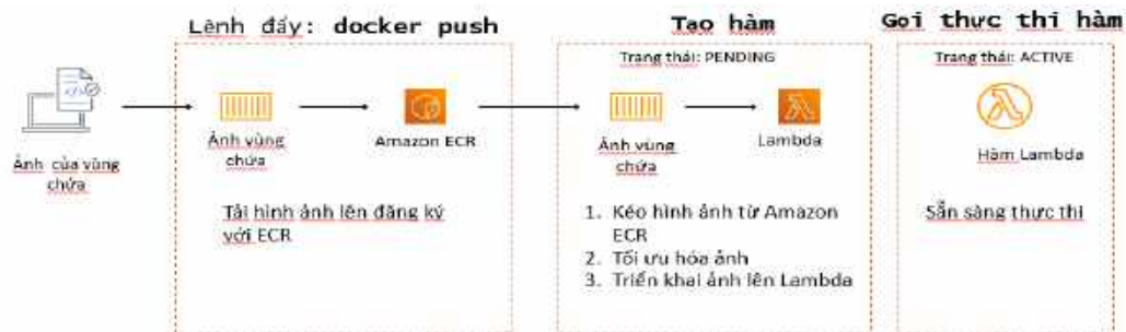
Hình 7: Triển khai ứng dụng dưới dạng hình ảnh khung chứa (Container Image)
