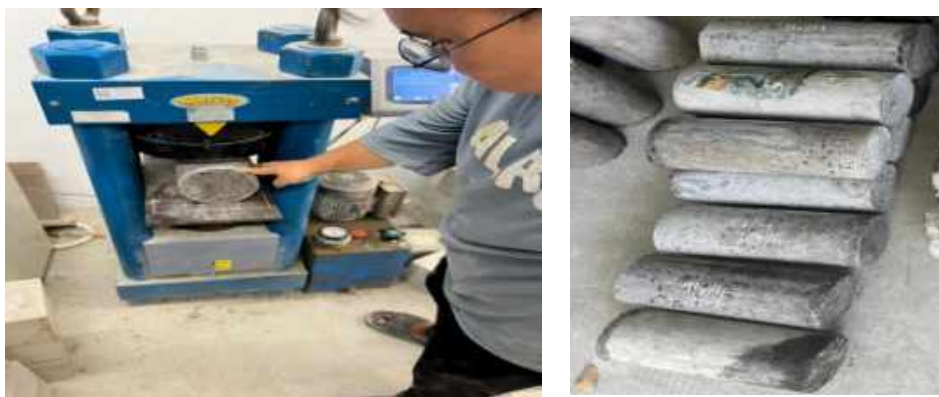
Hình 6. Thí nghiệm cường độ chịu kéo dọc trục
